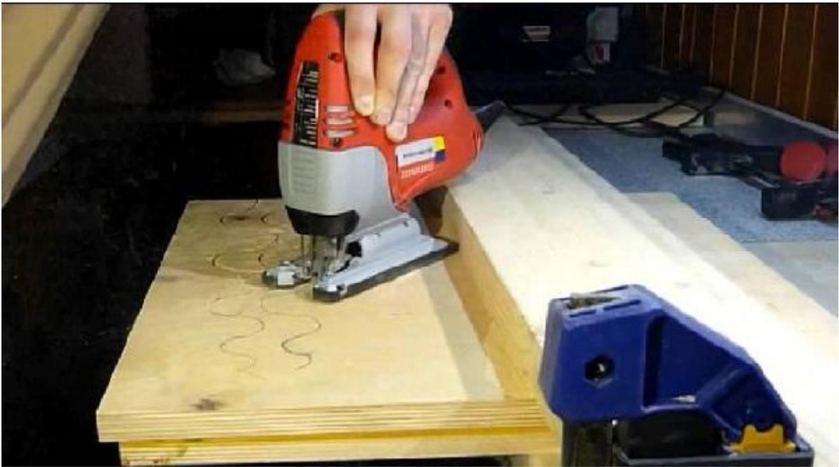
К недостаткам можно отнести его травмоопасность, поэтому он не подходит для детей. Электроинструмент имеет короткий ход полотна, поэтому толстые материалы пилит медленно. А также, по причине более толстого по сравнению с механическим, полотна, он не позволяет выполнять очень мелкие узоры.
