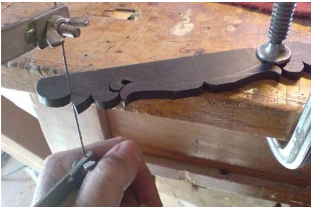
Особая конструкция этого инструмента позволяет выполнять распил и изнутри заготовки, дает возможность выполнять сквозные вырезы.
